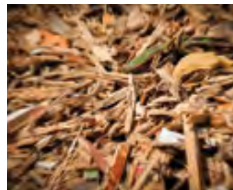
Le bois est déferrailé puis broyé avant d'alimenter une chaufferie.
